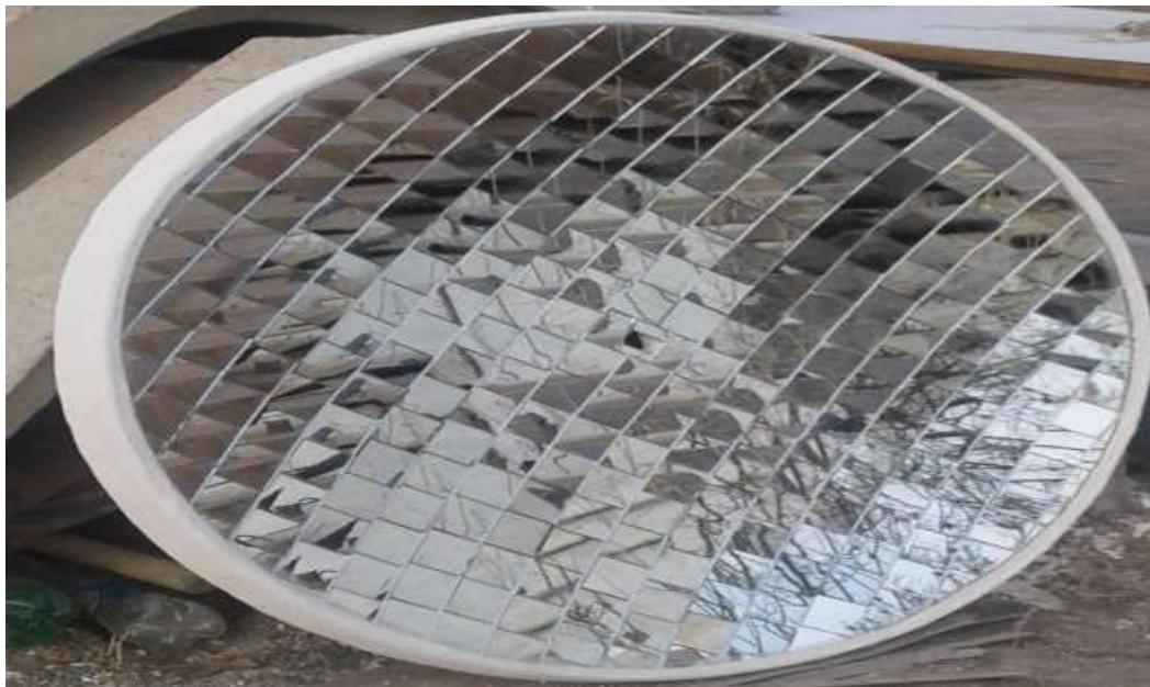
15-rasm. Sirti 5x5 sm o'lchamdagi ko'zgular bilan qoplangan paraboloidning haqiqiy ko'rinishi.
