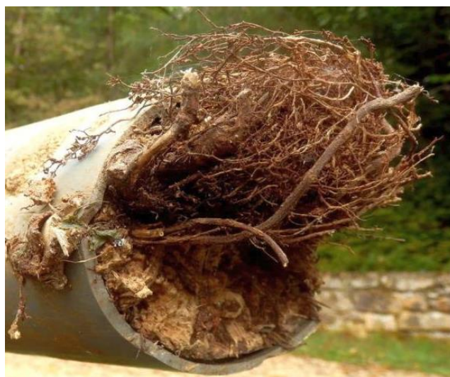
Rasm 3. Kanalizatsiya tarmog'ini o'simlik ildizlari bosishi
