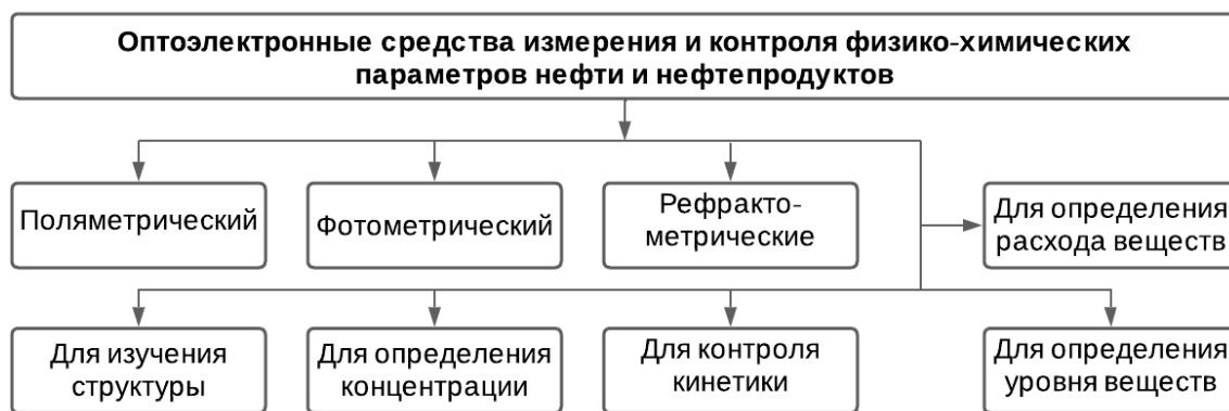
Рис. 1. Классификация оптических средств контроля физико-химических параметров нефтепродуктов
