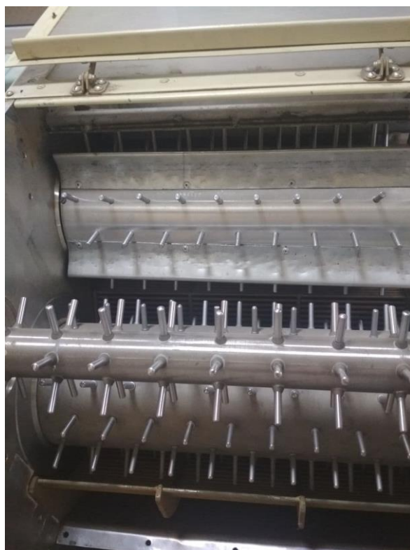
Рисунок 2. Установка колково-планчатого барабана на установку ЛКМ-3
