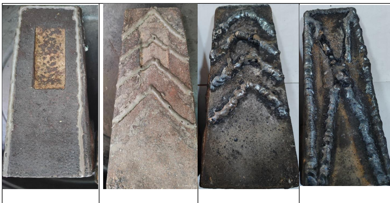
3-rasm. Zamonaviy kukunsimon kompozitsion materiallarni qo'llagan holda qobirg'a xosil qilib payvandlab qoplangan tishlar.
