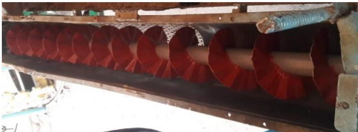
Рис.6. Общий вид винтового конвейера с зигзагообразным рабочим профилем для транспортирования и очистки хлопкового линта.
