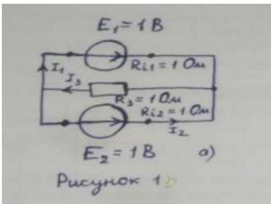
Решение: В данной цепи два источника ( $E_1$  и  $E_2$ ) потому необходимо составить и рассчитать две частичные цепи (рисунок 1,б и в). Рассчитаем ток  $I_1$ / (рисунок 1,б)
