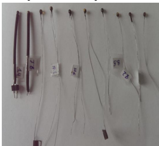
1-расм. Яратилинган терморезисторнинг ташқи куруниши.
