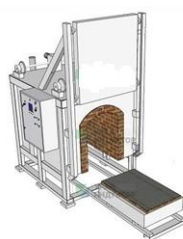
Маҳаллий хом-ашёларга асосланиб тайёрланган 1700^\circ\text{C} ҳароратда ишлайдиган термостатланган электр печи
