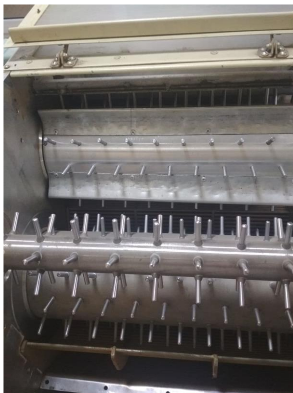
Рисунок 2. Установка колково-планчатого барабана на установку ЛКМ-3
