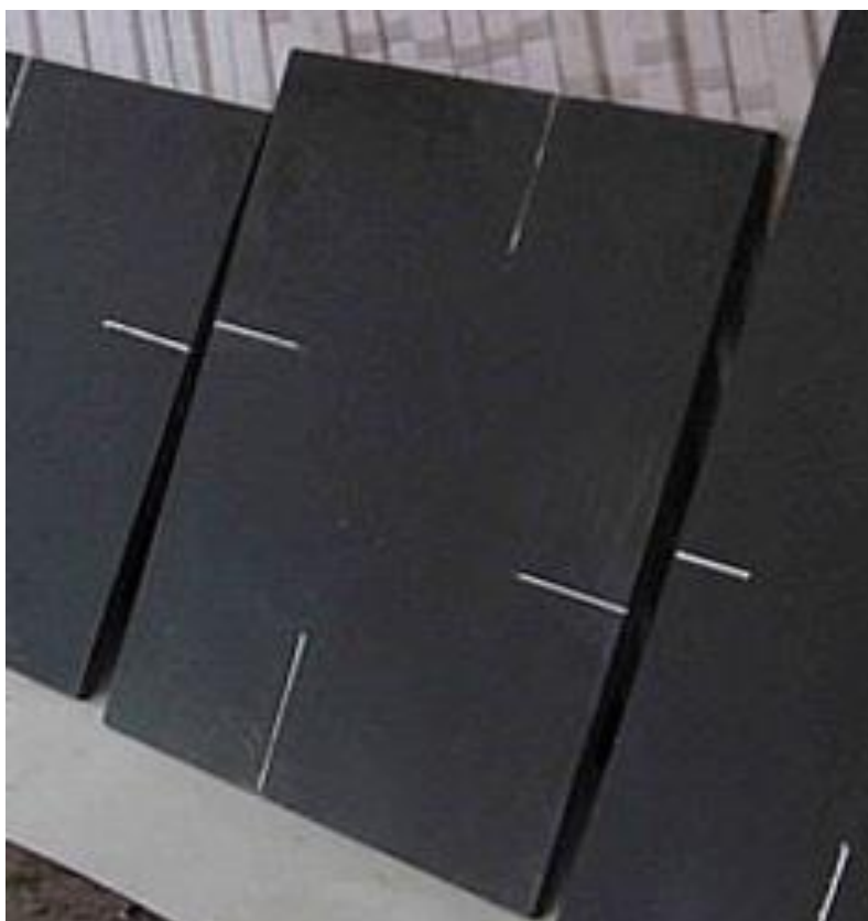
1-расм. Карбид кремний асосидаги импорт чинни буюм тайёрлаш плитаси.
